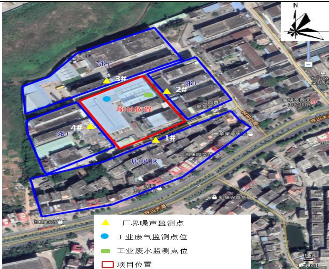
图 3-2 工业废水、工业废气、厂界噪声监测点布置图
